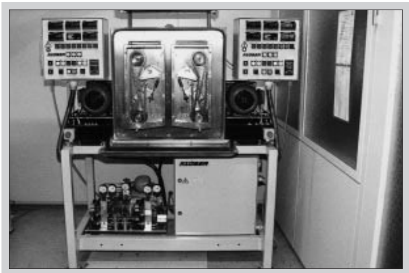
Rysunek 2 Stanowisko Klüber do badania łańcuchów
